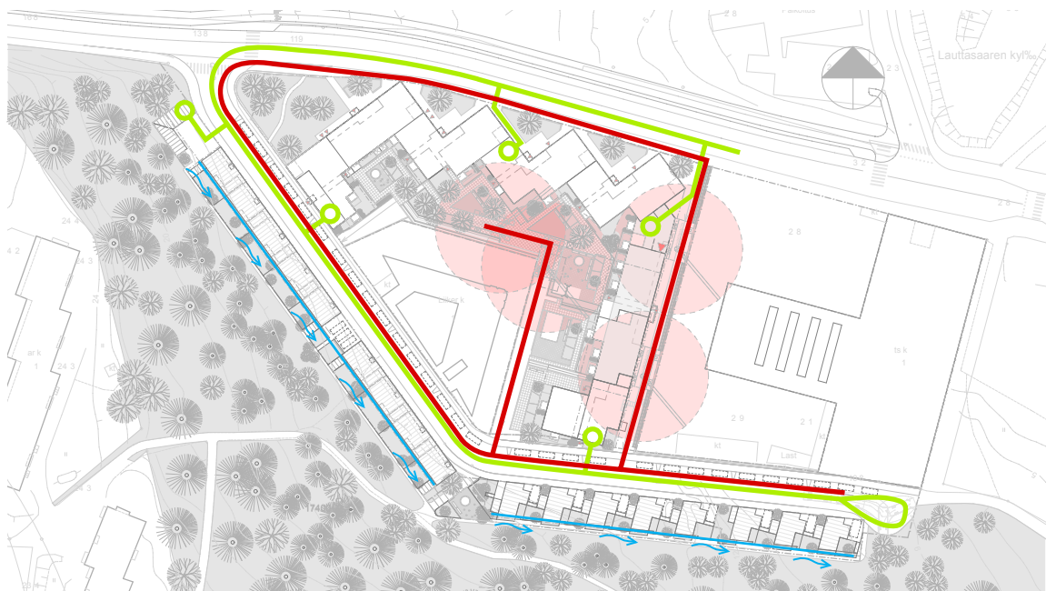
Jätehuolto- hulevesi- ja pelastuskaavio
