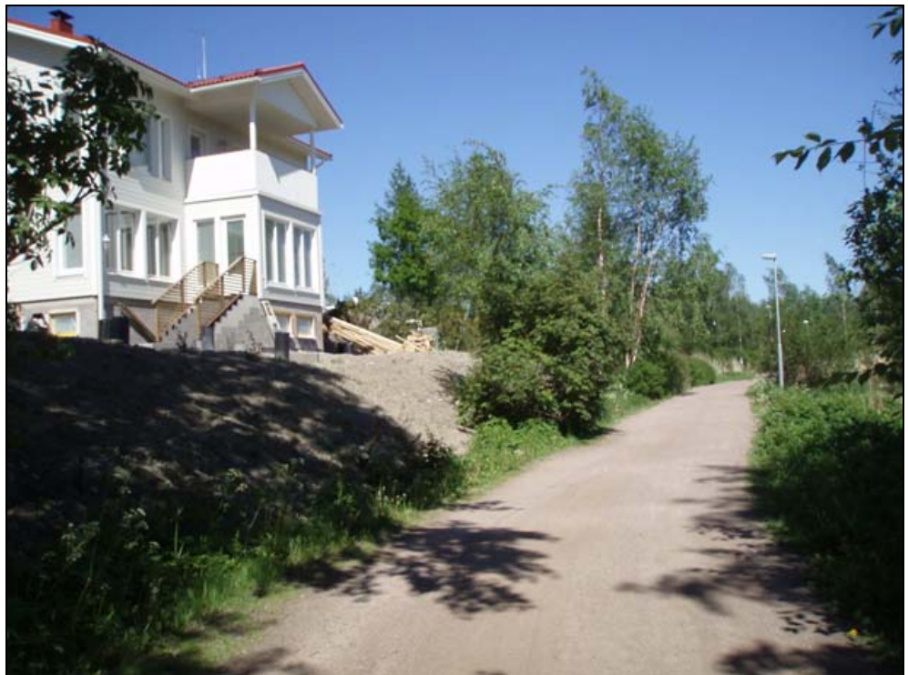
Kuva 2. Ranta-alueille rakennettaessa uusien rakennusten korkeusasemassa on otettu huomioon meriveden nousun mahdollisuus.
