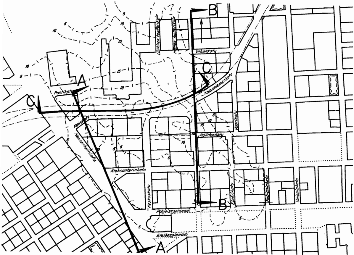
Kuva 5. Pohjasuhteet. Kuva 5a. Leikkausten paikat, saven alapinnan syvyyskäyrät.
