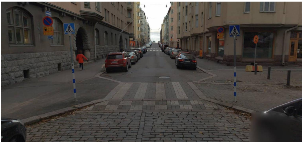
Kuva 6.1. Korotettu ja kavennettu suojatie Rauhankadun ja Ritarikadun risteyksessä. (Helsingin karttapalvelu 2021)
