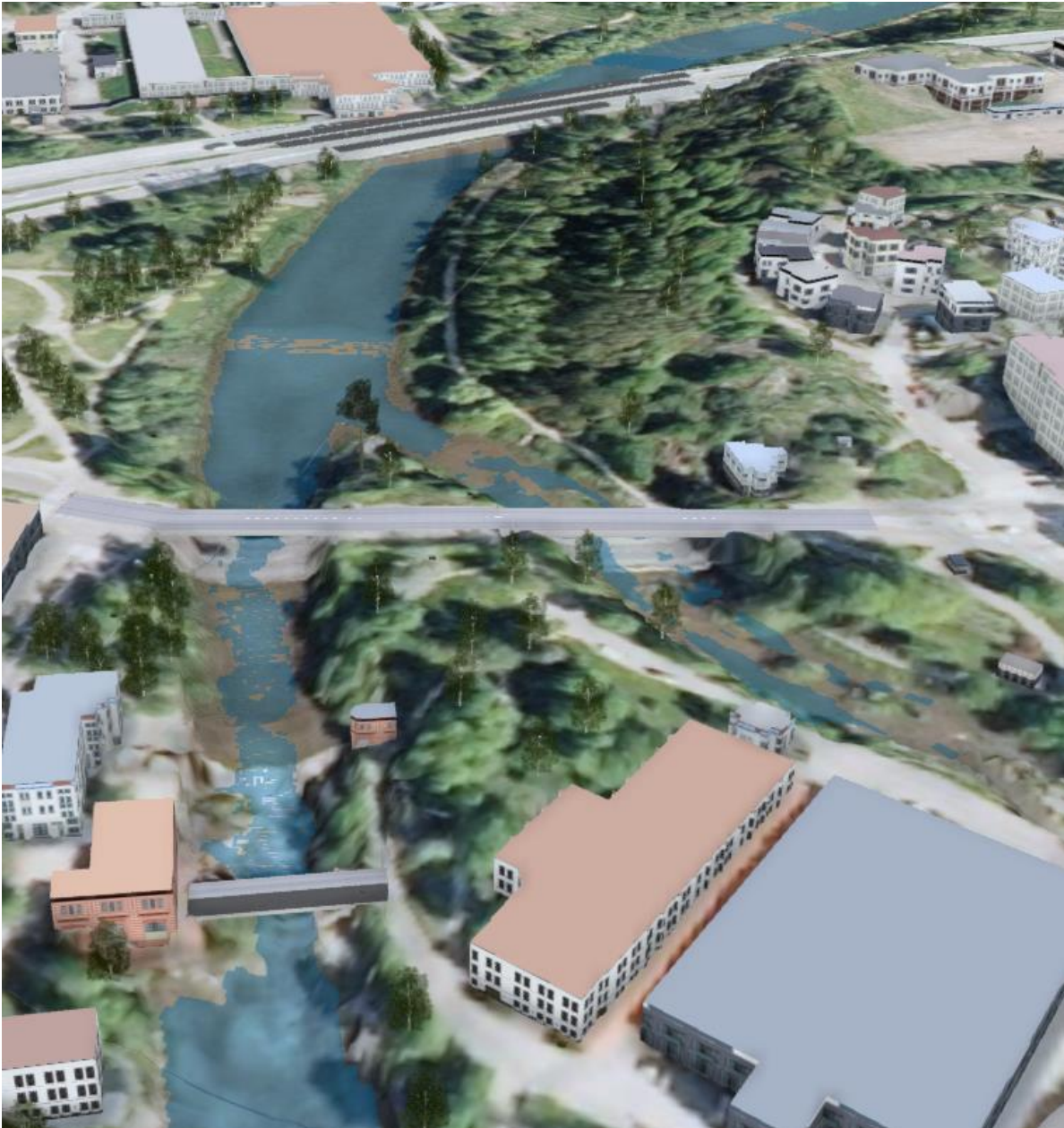
Kuva 32 Skenaariion 4 havainnekuva Vanhankaupunginkosken padon kohdalta pohjoisen suuntaan. Simuloitu keskialivirtaaman aikainen vedenpinta. Havainnekuva laadittu Autodeskin InfraWorks-ohjelmistossa.
