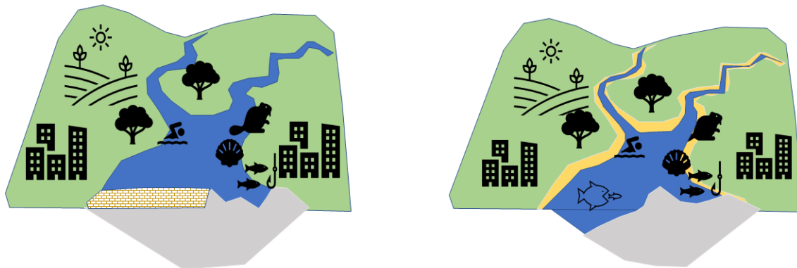
Kuva 34 Konseptuaalinen malli padon purkamisen vaikutuksesta. Vasen: nykytila, oikea: purku osittain tai kokonaan. Purkamisen seurauksena veden pinta laskee, jolloin joen penkereet jäävät osittain kuiville. Myös virtausnopeuksissa tapahtuu muutoksia.
