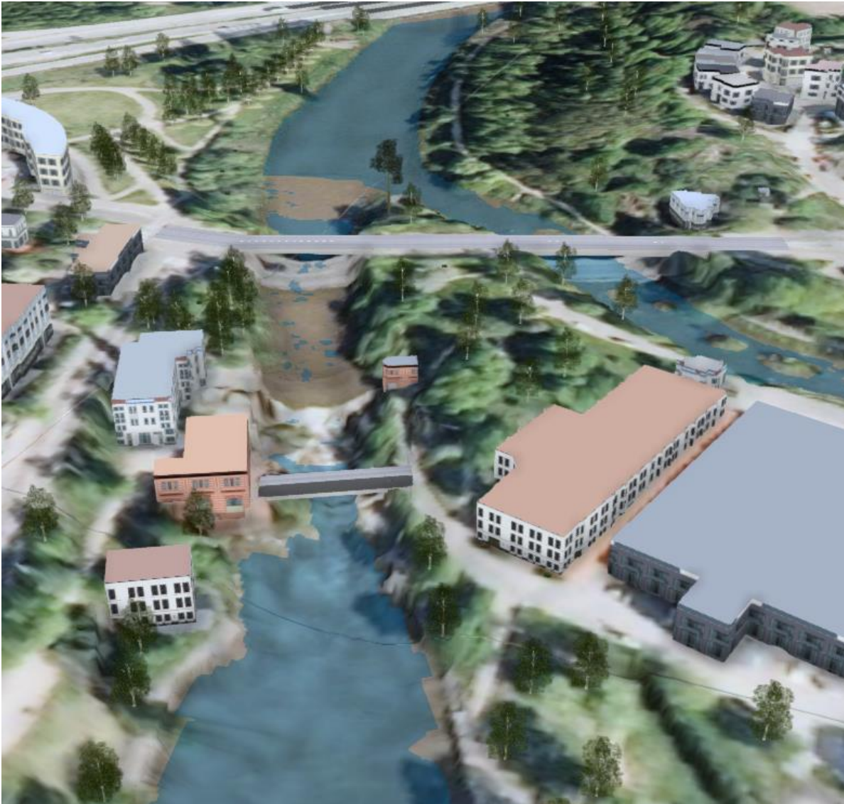
Kuva 30 Skenaarion 3 havainnekuva Vanhankaupunginkosken padon kohdalta pohjoisen suuntaan. Simuloitu keskialivirtaaman aikainen vedenpinta. Havainnekuva laadittu Autodeskin InfraWorks-ohjelmistossa.
