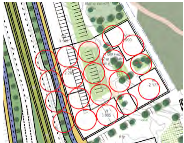
Kuva 27. Maalämpökaivojen sijoittamisen hahmotelma korttelissa 1.
