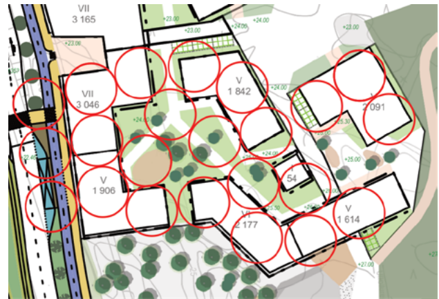
Kuva 30. Maalämpökaivojen sijoittamisen hahmotelma korttelissa 2.
