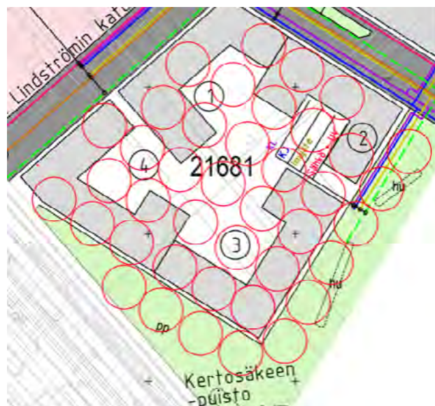
Kuva 7. Maalämpökaivojen sijoittamisen hahmotelma korttelissa 21681.
