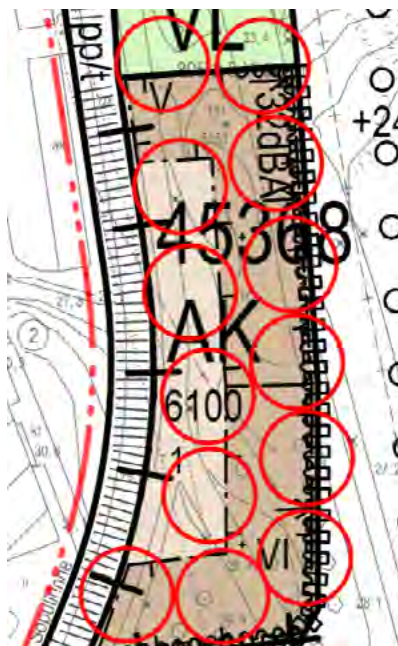
Kuva 17. Maalämpökaivojen sijoittamisen hahmotelma korttelissa 45368.
