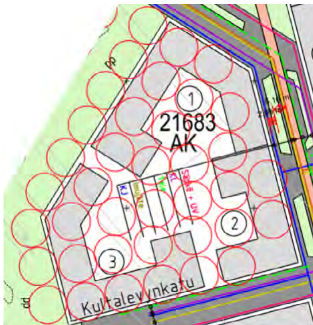
Kuva 10. Maalämpökaivojen sijoittamisen hahmotelma korttelissa 21683.
